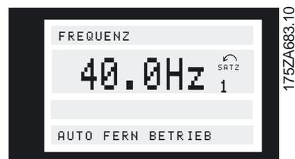
Zeile 2 enthält die aktuelle Ausgangsfrequenz und den aktiven Parametersatz.
