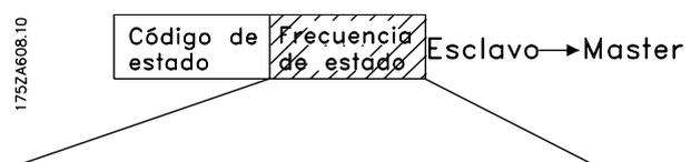
El valor de la velocidad real del motor se transmite en forma de un código de 16 bits.
