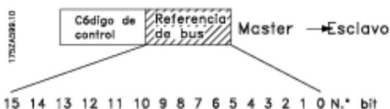
El valor de referencia de la velocidad se transmite al convertidor de frecuencia VLT en forma de un código de 16 bits. El valor se transmite como un número entero; las cifras negativas se forman por medio del complementario de 2.
