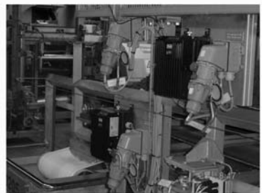
Illustration 1.17: Effektiv brug af plads i fødevareindustrien med decentral motorregulatorer fra Danfoss
