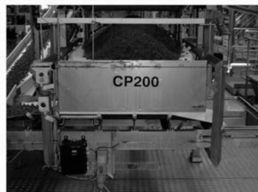
Illustration 1.16: Effektiv brug af plads i fødevareindustrien med decentral motorregulatorer fra Danfoss
