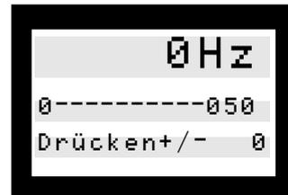
**Stop Reset** Diese Taste dient zum Stoppen des angeschlossenen Motors. Bei Aktivierung der Stopfunktion beginnt die obere Zeile im Display zu blinken. Diese Taste im Bedienfeld des Frequenzumrichters unterbricht die Netzversorgung nicht und darf daher nicht als Sicherheitsschalter benutzt werden.
